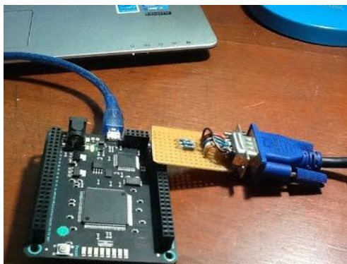
รูปที่ 6 การต่อความต้านทานเข้ากับหัวต่อ DB15
