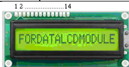
รูปที่ 7 แสดงตำแหน่งขาของ โมดูลแอลซีดี
