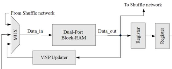
(d) Register insertion in all VNPs of Scheme 2
