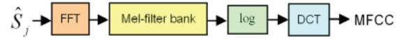
รูปที่ 3 ขั้นตอนการดึงค่าลักษณะสำคัญ MFCC
