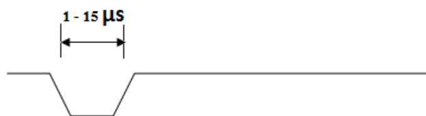
รูปที่ 9 สัญญาณ Write สำหรับ ลอจิก 1
