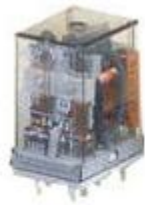
รูปร่างของรีเลย์ที่มีตัวถัง เป็นพลาสติกใสป้องกันฝุ่น
